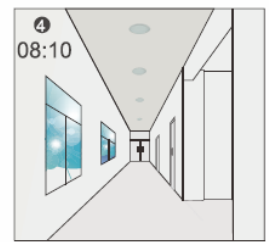
Cuando el nivel de luz natural supera el punto de ajuste de apagado a luz, la luz se apagará incluso cuando el espacio esté ocupado.
